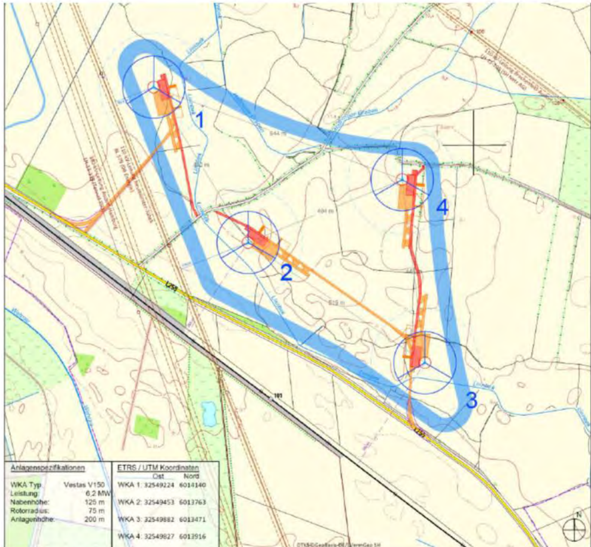
Abb.: Lage der geplanten WKA und der Trassen der Freileitungen, projektbezogene Arbeitsräume für die Montagekrane für die Errichtung und betriebsbedingte Arbeiten an der jeweiligen WKA (aus: TÜV NORD EnSys GmbH & Co. KG, 2022)
