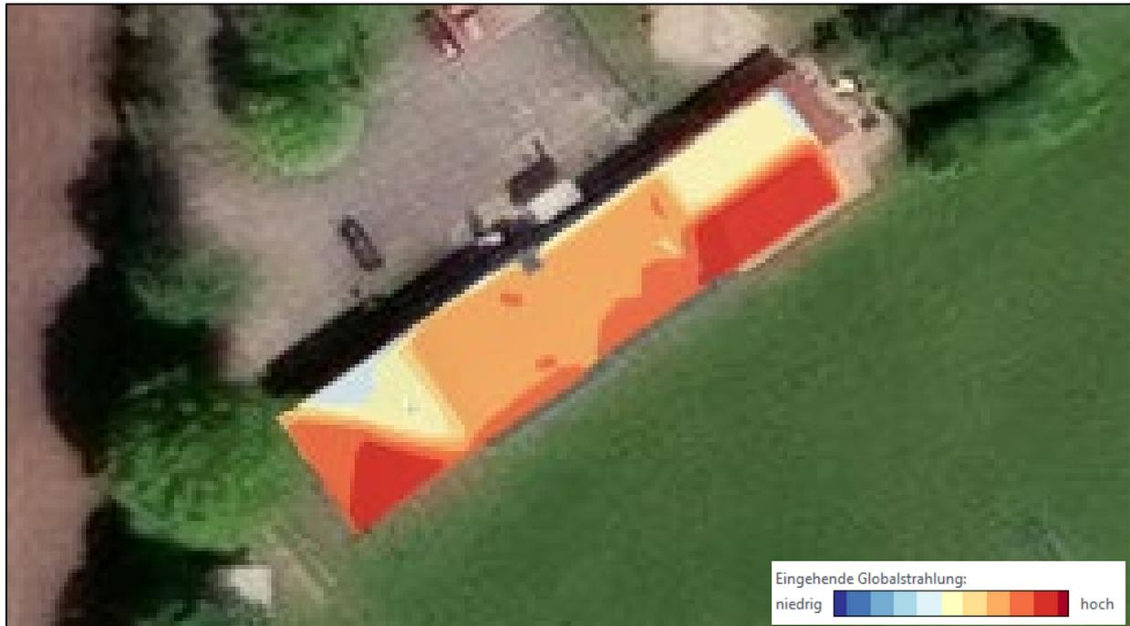
Abbildung 2: Globalstrahlung Dachflächen FFW/ Kita/ Haus der Jugend. Bildquelle: Solardachkataster RD-ECK, Abrufdatum: 19.02.2025
