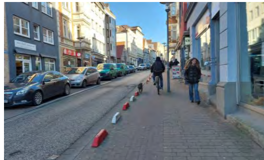
Sicherung von Geh- und Radwegen gegen Falschparker
