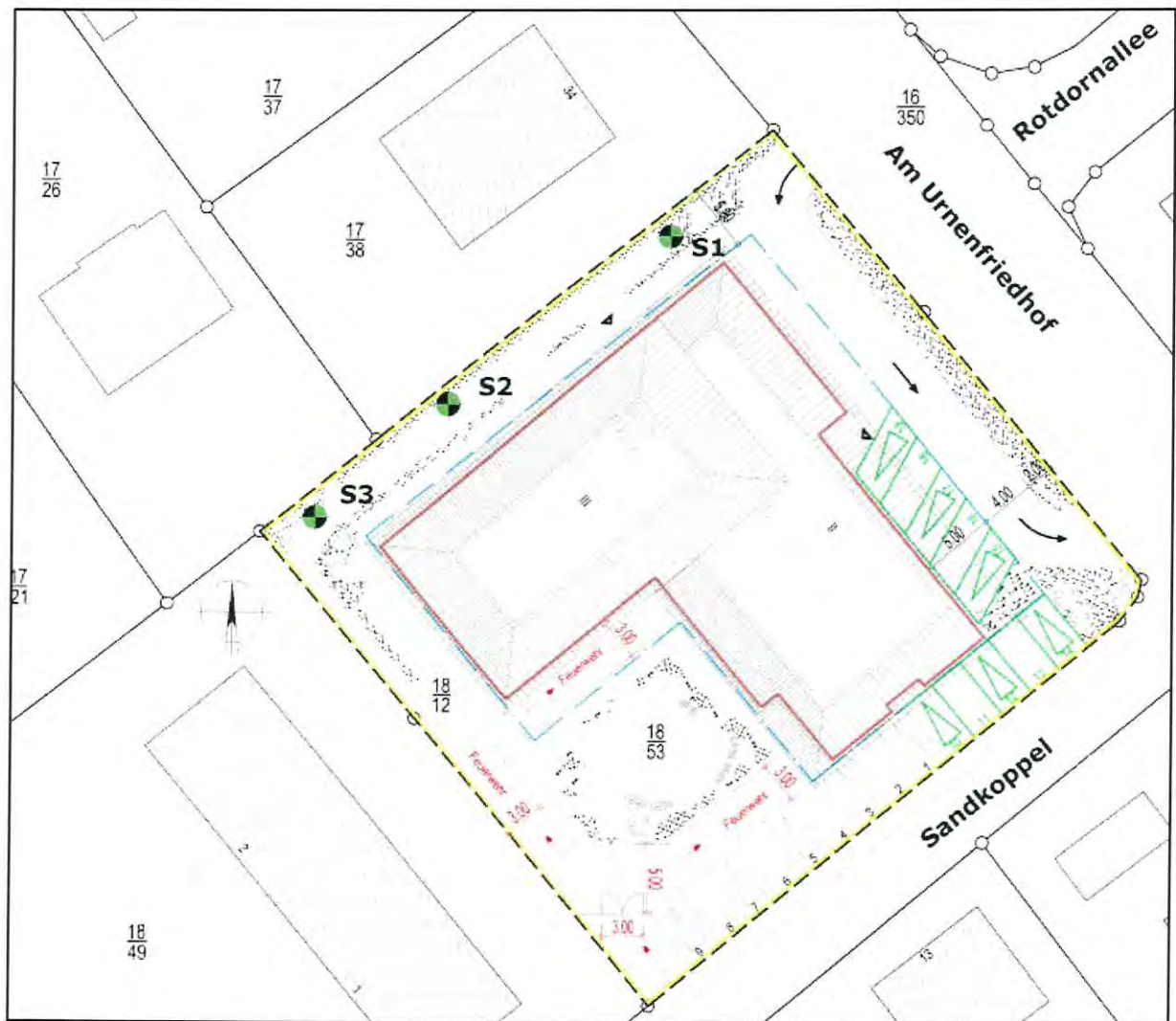
Abb. 1: Lage der Schurfe, ausgeführt am 30.11.2017
